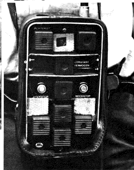
Het omlopen van de gerangeerde trein van verdeel spoor naar vertrek spoor geschiedt m.b.v. radiografisch bestuurd locomotieven; 6 juli 1985.
