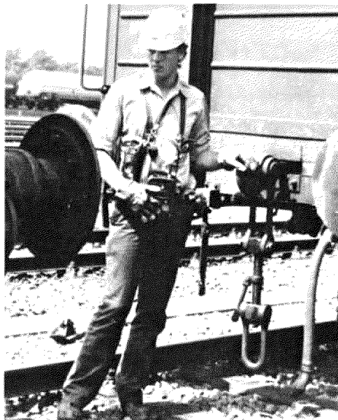
Het omlopen van de gerangeerde trein van verdeel spoor naar vertrek spoor geschiedt m.b.v. radiografisch bestuurd locomotieven; 6 juli 1985.
